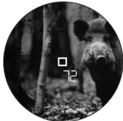
Con Leica Geovid HD-R è possibile eseguire misurazioni anche a ciclo continuo (modalità Scan): tenere premuto il pulsante principale /di azionamento alla seconda selezione. Dopo circa 2,5 secondi, il dispositivo entra in modalità Scan ed esegue misurazioni a ciclo continuo. La modalità Scan si riconosce dal cambiamento dell'indicatore: a intervalli di circa un secondo viene visualizzato continuamente un nuovo valore.
