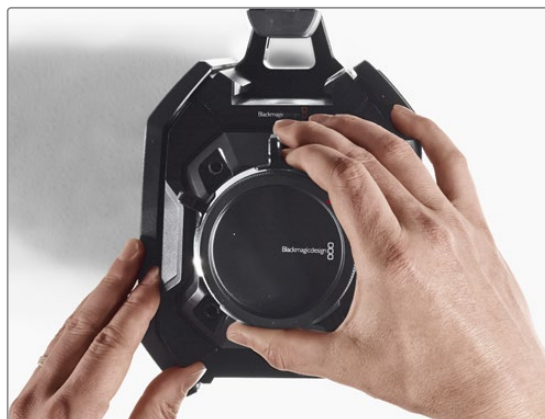
ステップ8. タレットを取り外す際、隣接したデータコネクタがカメラ筐体から外れます。
