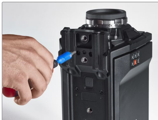
ステップ4. 4.0mmの六角レンチを使って15mmレールマウントを取り外します。
