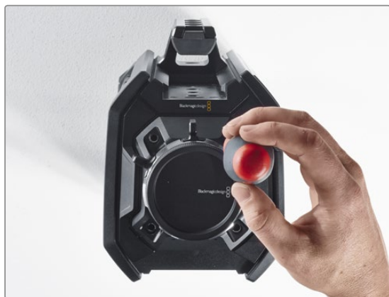
ステップ7. 4つのネジを外し、センサータレットを取り外します。
