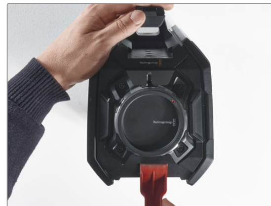
ステップ6. 楔形のプラスチック製のとこを使い、センサータレットをカメラ筐体から浮かせます。
