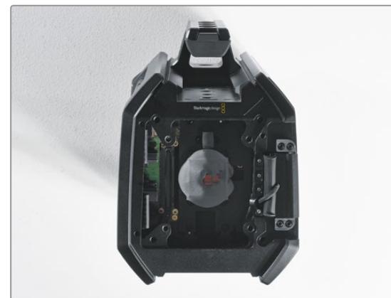
ステップ9. 楔形のプラスチック製のとこを使い、保温性のギャップパッドを大小の銅プレートから外します。カメラ筐体内部の銅プレートとセンサータレットを柔らかい布で拭き、埃を完全に取り除きます。洗剤は使用しないでください。
