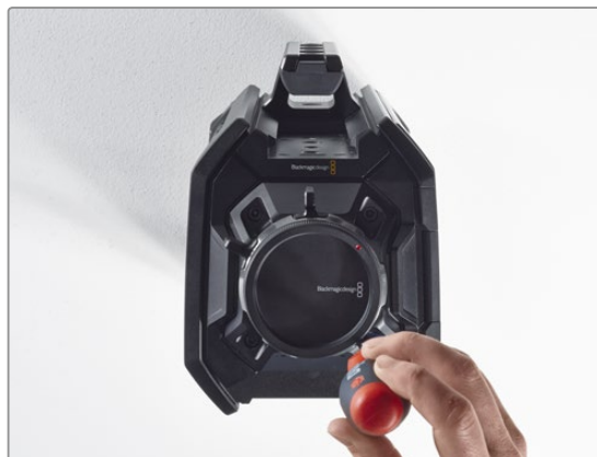
ステップ5. 4つのセンサータレットマウントネジを、4.0mm六角レンチを2度フル回転して緩めます。
