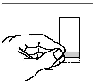
Roulez la feuille en cylindre et humectez une des extrémités seulement avec le liquide de nettoyage optique.
