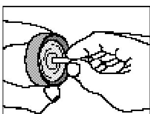
En commençant au centre des lentilles, frottez délicatement en effectuant un mouvement circulaire, du centre vers l'extérieur.
