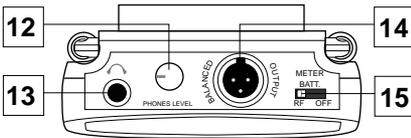
**12. Lautstärkereglertaste** - Diese Taste regelt den Pegel des Audiosignals, das dem Kopfhörer-Ausgang zugesendet wird (s. unter Nr 13).
