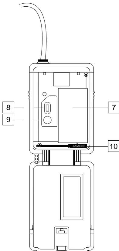
**8: Commutateur d'alimentation-Power On/Off** \* - Utilisez ce commutateur pour mettre sous/hors-tension les émetteurs UT1L /UT1G (pour ne pas user la pile, veillez à le laisser sur "Off" lorsque vous ne l'utilisez pas).
