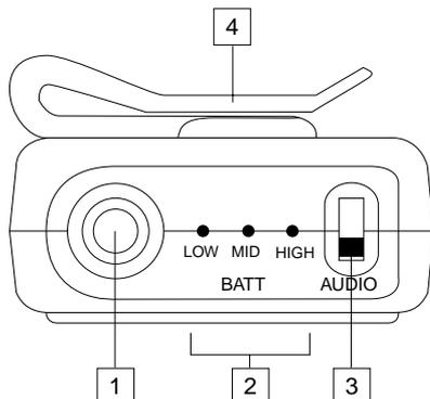
**1: Conector de entrada** - Aquí se conecta la unidad de entrada. El UT1L viene con un micrófono lavalier o de diademaes (conectado a través de una toma Switchcraft mini-XLR), mientras que el UT1G viene con un conector de 1/4" permanente.
