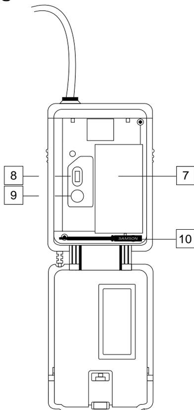
**8: Interruptor on-off de encendido\*** - Utilice este interruptor para encender o apagar el UT1L / UT1G (para mantener la pila durante más tiempo, asegúrese de dejar la unidad apagada cuando no la utilice).
