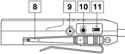
Videokamera zu erhalten (+ - Inneres; - - Äußeres). Schließen Sie auf Wahl den Samson AC300R Adapter an diesen Eingang an, um eine aufladbare 9-Volt NiCad-Batterie wieder aufzuladen.
