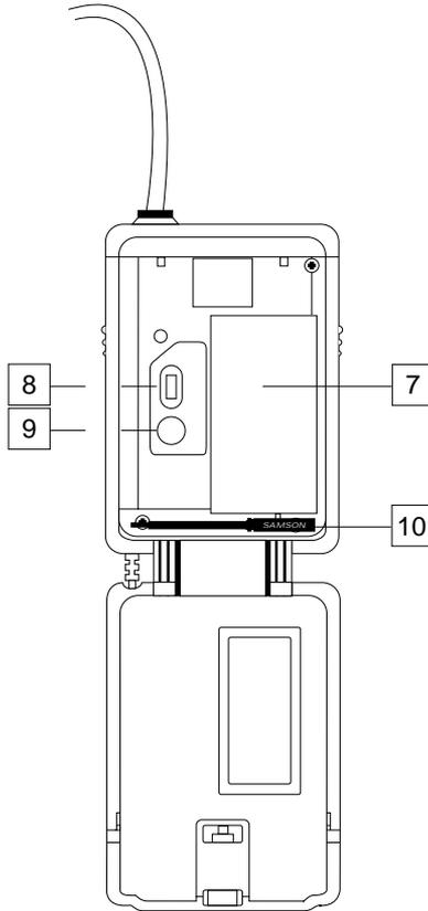
**8: Power-Schalter\*** - Schalten Sie den Sender mit diesem Schalter ein und aus. Wenn Sie den Sender für längere Zeit nicht verwenden, schalten Sie den Schalter aus („Off“), um die Lebensdauer der eingelegten Batterie zu verlängern.
