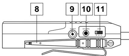
**9 : Connecteur d'alimentation** - Ce connecteur accepte une tension continue de 6 à 13 Volts (point chaud sur [pointe], masse sur [corps]) en provenance de la caméra vidéo, si disponible. Reliez à ce connecteur l'adaptateur Samson AC300R optionnel permettant de charger une pile 9 Volts Nickel-Cadmium rechargeable.
