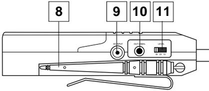
**10: Salida no balanceada\*** - Utilice este conector mini-jack de auriculares de 1/8" (3.5 mm) no balanceado (1K Ohm máximo) cuando conecte el UM1 a unidades de sonido no profesionales (-10). El cableado es el siguiente: punta-activo, lateral-masa. Si su cámara de vídeo tiene entradas audio stereo, deberá usar un adaptador en Y que tenga en
