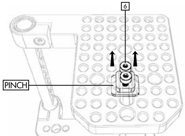
7. Align **TOP** rod hole with **BASE** rod hole
